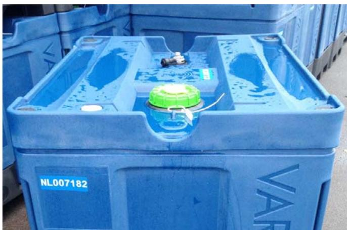
Bild 3-6: Doppelwandiger Säuretank
