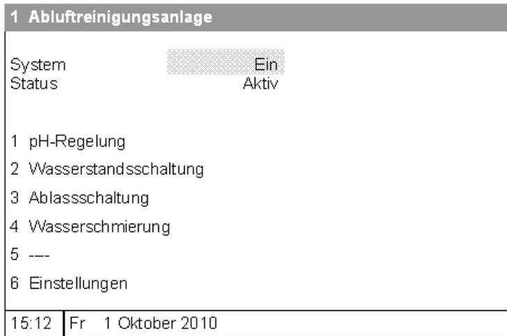
Bild 7-33: Menü Abluftreinigungsanlage - Betriebsmodus
