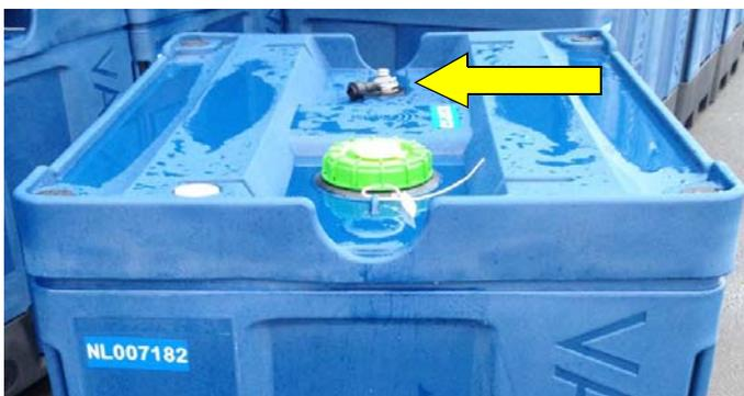
Bild 7-7: Schnellkupplung am Säuretank
