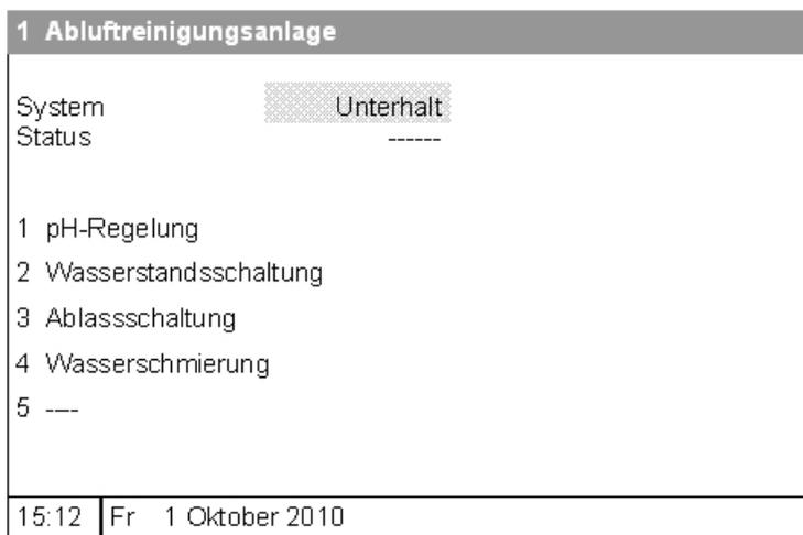
Bild 7-22: Menü Abluftreinigungsanlage - Wartungsmodus
