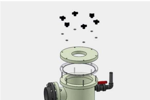
Bild 7-25: Flansch am Filtergehäuse
